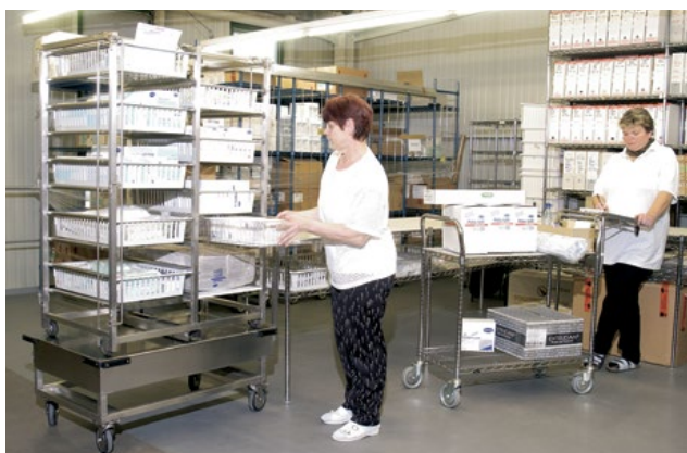
Shuttle binnenwagen op een shuttle beladingswagen in AGV-systeem tijdens orderpicken
