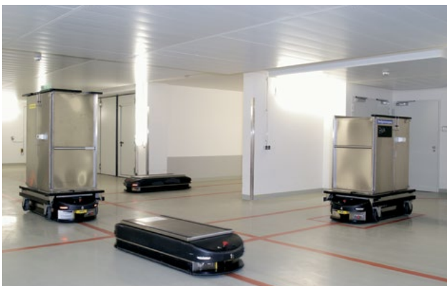
AGV-transportunits worden automatisch naar hun bestemming geleid
